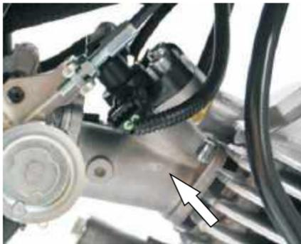
L'ensemble de tuyau d'admission est relié à un ensemble de soupape entre les parties du bloc moteur, le canal d'entrée fournit le mélange d'air et de carburant au moteur, de manière à assurer le fonctionnement normal du moteur sous divers conditions. Vérifiez le tuyau d'admission régulièrement pour voir s'il y a des fuites, que les colliers sont bien serrés ou non.
