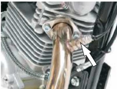
Le capteur d'oxygène est installé sur l'extrémité avant de la pile d'échappement, qui consiste à détecter la concentration d'oxygène dans les gaz d'échappement, ECU ajuste la quantité de carburant à injecter selon l'information en temps réel de manière à maintenir le rapport air-carburant optimum.
