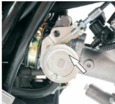
L'ensemble du corps de l'accélérateur comprend une vis de ralenti, une vanne de régulation, un capteur de position de l'accélérateur, un capteur de pression.
