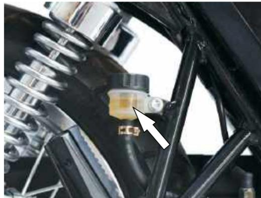
Faire attention à ne pas avoir d'air dans le circuit de frein cela entraînerait un défaut de freinage. Avant de partir, contrôlez le niveau soit au-dessus du minimum, si nécessaire ajouter du liquide de frein.
