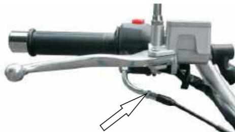
1. Desserrez l'écrou de blocage.
