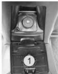
L'ouverture de la trappe d'accès au remplissage d'essence se fait par appui sur le loquet (1).
