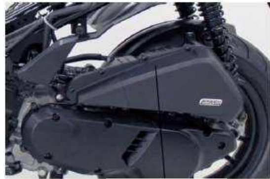
Ensemble filtre à air
