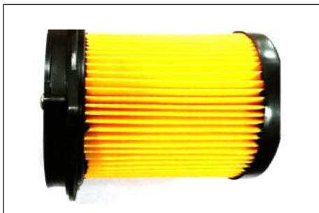
Le filtre à air doit être entretenu régulièrement. L'entretien du filtre à air doit être plus fréquent si vous conduisez dans des zones poussiéreuses ou venteuses.
