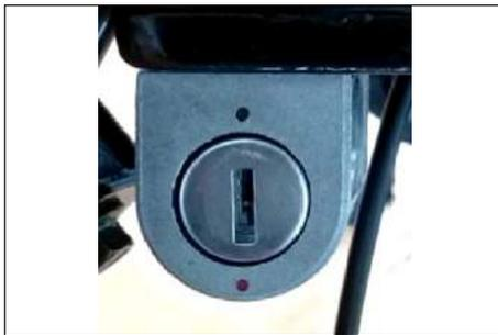
Insérer la clé dans la serrure de direction. Elle est située sur le côté inférieur droit de la tête de fourche. Tourner le guidon jusqu'à la position d'arrêt, vers la gauche et la clé dans le sens inverse des aiguilles d'une montre, jusqu'au point rouge et jusqu'à ce que la goupille de sécurité s'emboîte. Ensuite, la clé peut être retirée.
