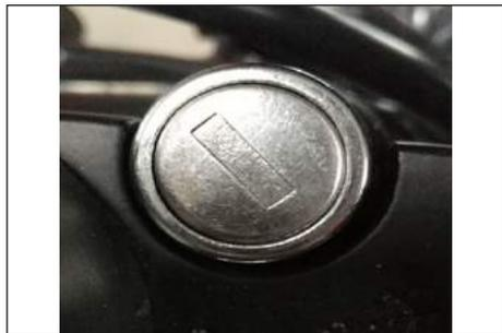
En tournant la clé dans le sens des aiguilles d'une montre, le véhicule s'allumera, le moteur peut être démarré et la clé ne peut pas être enlevée. En tournant la clé dans le sens inverse des aiguilles d'une montre, le véhicule est éteint, le moteur ne peut pas être démarré, et la clé peut être retirée.
