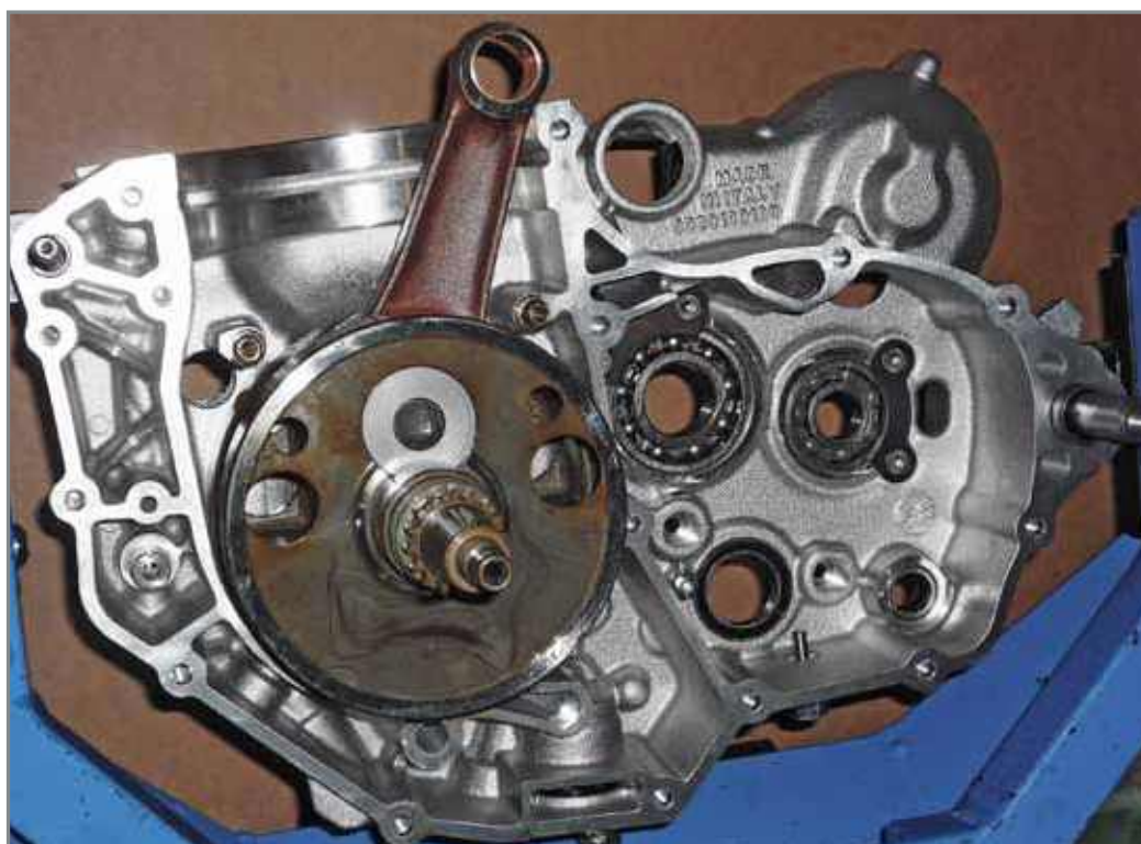
Introduction du vilebrequin dans le carter droit: noter la position de l'engrenage.
