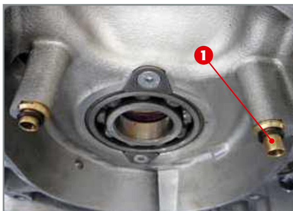
Mise en place des gicleurs d'huile du piston.
