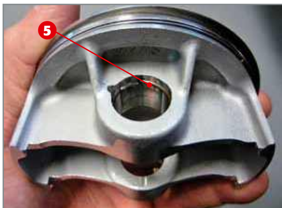
Application du circlip 5 sur le piston.
