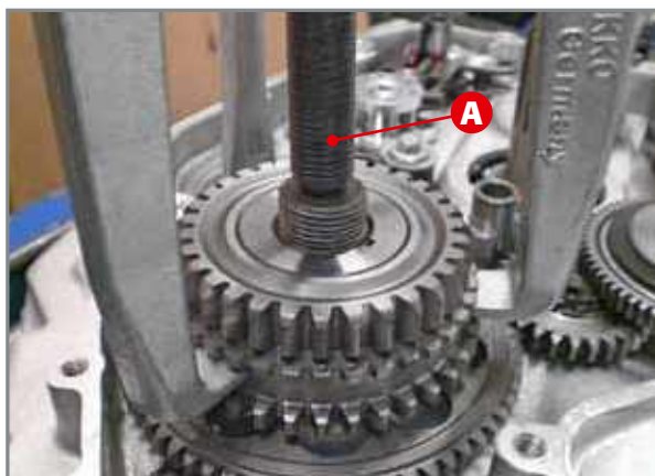
Extraction du pignon en bout de vilebrequin à l'aide de l'extracteur A.
