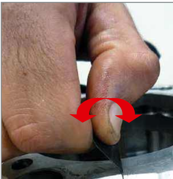
Découpe de l'excédent de joint entre le demi-carter du moteur.
