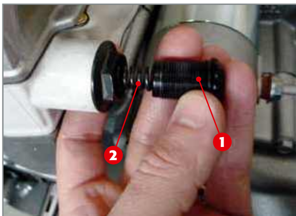
Bouchon du tendeur mécanique.
