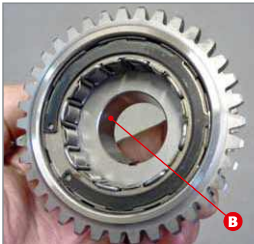
Section conique B pignon en bout de vilebrequin.
