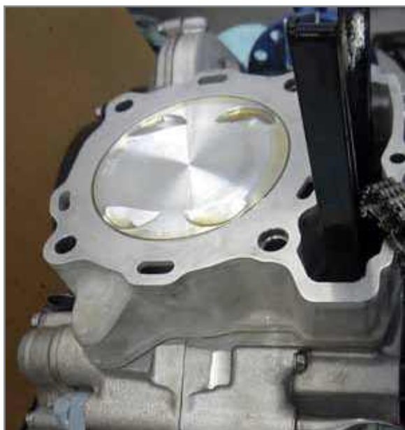
Montage cylindre sur le bas moteur.
