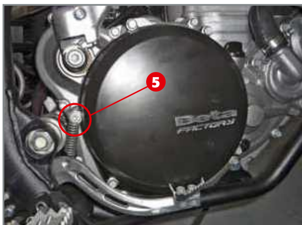
Détail de la vis 5 à appliquer avec le moteur en place .
