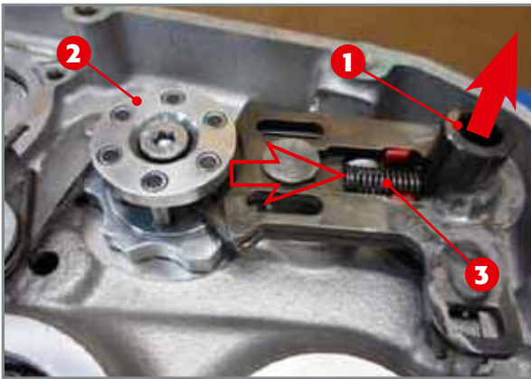
Démontage de l'axe de la boîte de vitesse.
