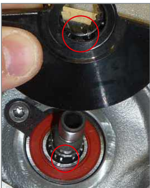
Détail des profils cannelés pour le couplage.
