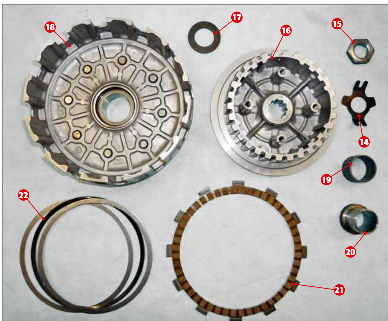
La rondelle de sécurité 14 ; l'écrou 15 ; le tambour d'embrayage 16 ; la rondelle 17 ; la cloche 18 ; la cage à rouleaux 19 ; la bague 20 ; le disque entraîné spécial 21 ; l'ensemble rondelle ressort 22.
