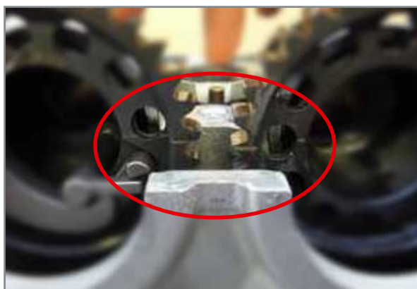
Détail de l'alignement correct des traces gravées sur les roues dentées des arbres à cames.
