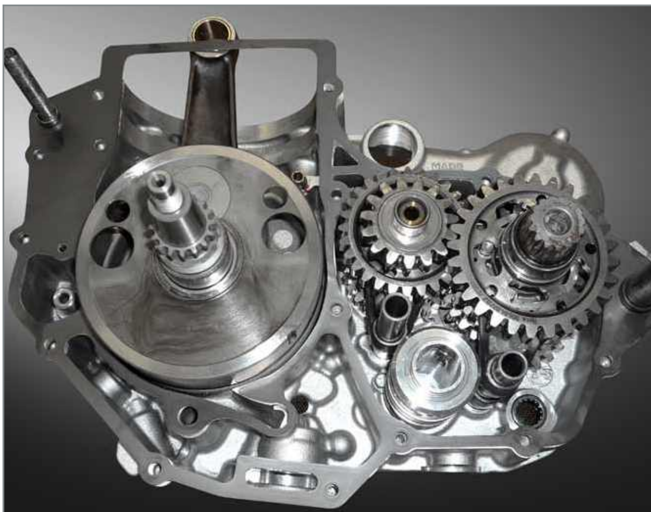
Vue de l'intérieur du carter droit avec l'arbre moteur, des gicleurs d'huile, des arbres de boîte dotés de roues, une commande de boîte interne et un garniture.
