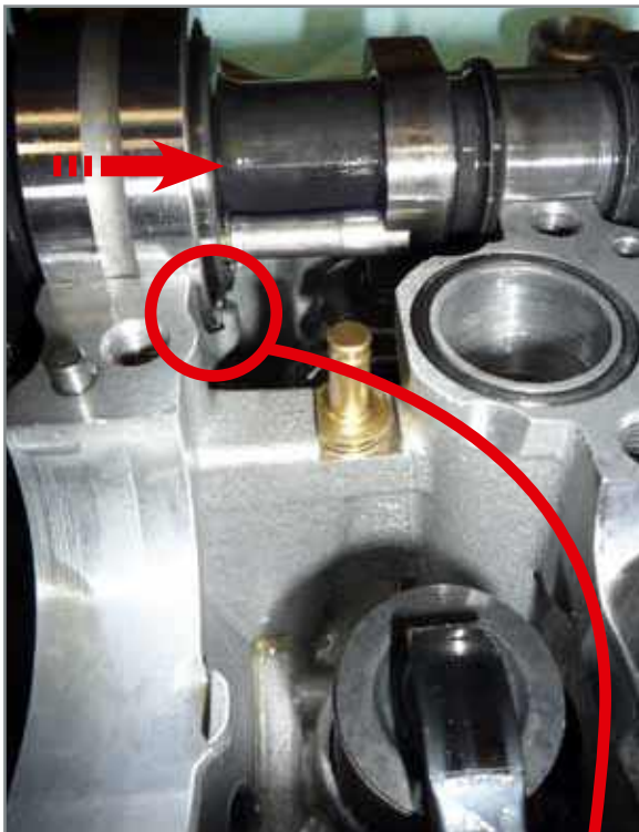
Positionnement du palier de l'arbre à cames.
