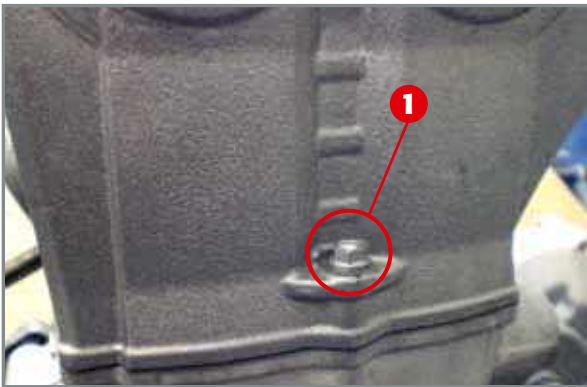
Vis de fixation de la tête côté chaîne.
