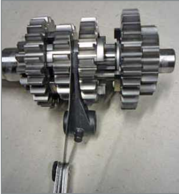
Contrôle de l'usure des fourchettes et des pignons.
