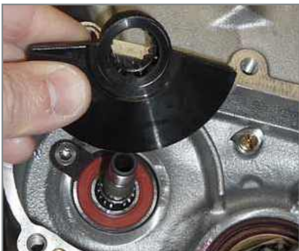
Couplage du contrepois à l'arbre d'équilibrage.
