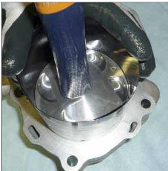
Insertion du piston dans le cylindre.
