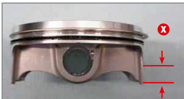
Hauteur à laquelle effectuer la mesure du diamètre extérieur du piston.
