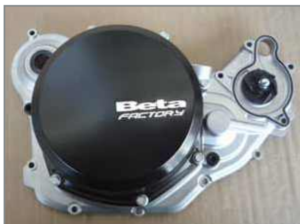
Carter d'embrayage interne équipé d'une pompe à eau.
