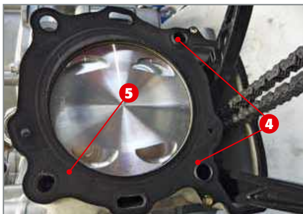
Application des bagues guides 4 et de la garniture 5 sur le cylindre.
