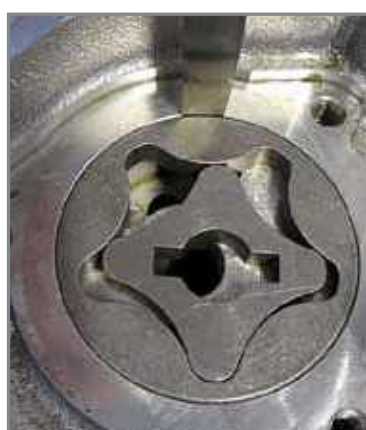
Evaluation du jeu radial entre rotor externe et carter.
