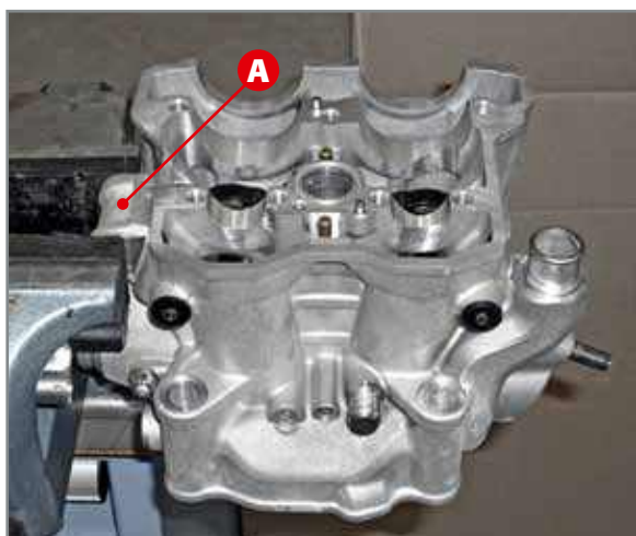
Blocage de la culasse dans l'étau.
