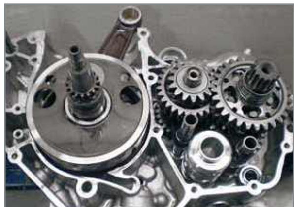
Le demi-carter droit (côté interne) avec arbre moteur et groupe boîte de vitesse.
