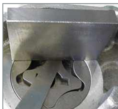
Evaluation du jeu axial entre les rotors et le rotor surfaces de frottement.
