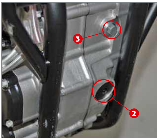
Vis 2 d'écoulement de l'huile moteur et 3 d'écoulement de l'huile de boîte de vitesse.
