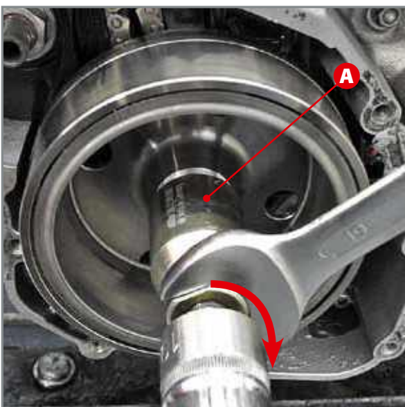
Extraction du volant moteur de l'allumage avec l'extracteur spécifique A.
