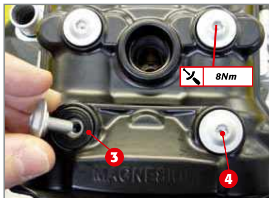
Montage des bagues caoutchouc 3 et des vis de fixation 4.
