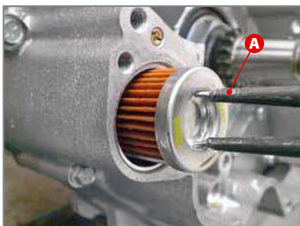
Extraction du filtre avec des pinces A.
