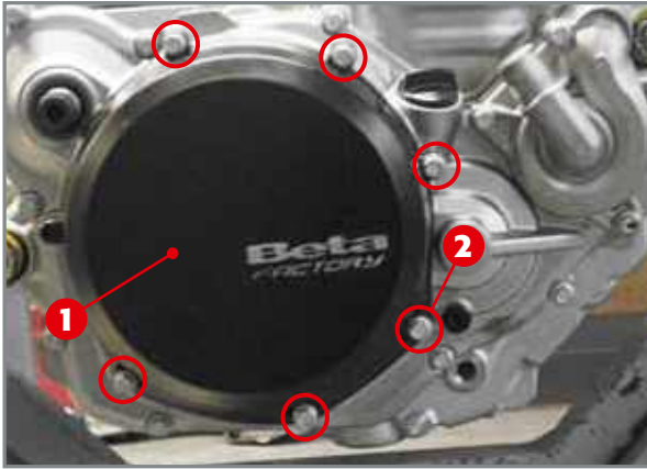
Le carter à l'extérieur de l'embrayage 1 et les vis correspondantes 2.
