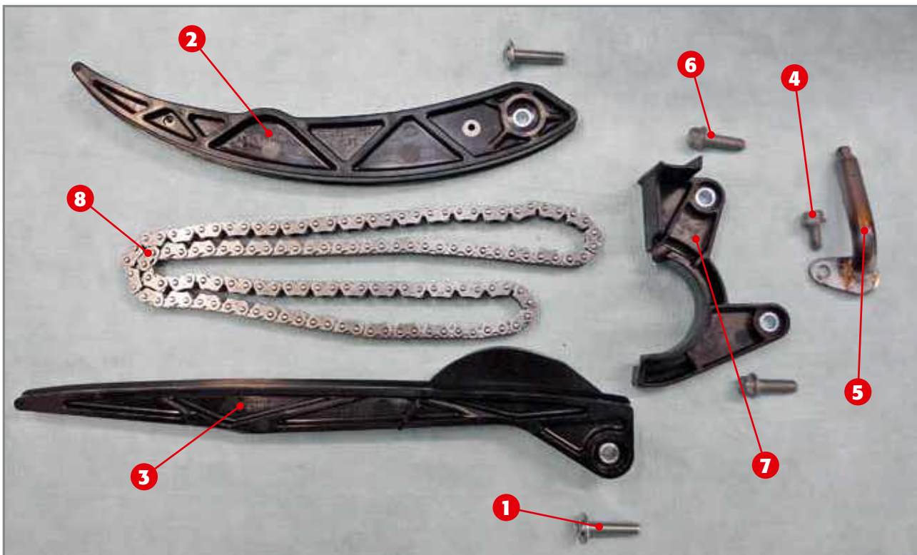
Les deux vis de fixation du patin 1 ; le patin mobile 2 ; le patin fixe 3 ; la vis de fixation du gicleur d'huile 4 ; le gicleur d'huile 5 ; les vis de fixation du carter de chaîne 6 ; le carter de chaîne 7 ; la chaîne de distribution 8.
