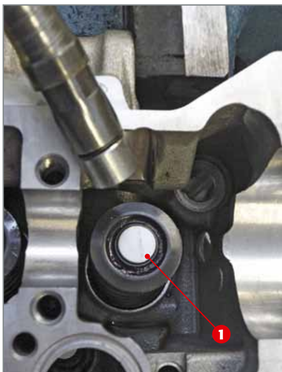
Extraction des disques calibrés de leurs logements.
