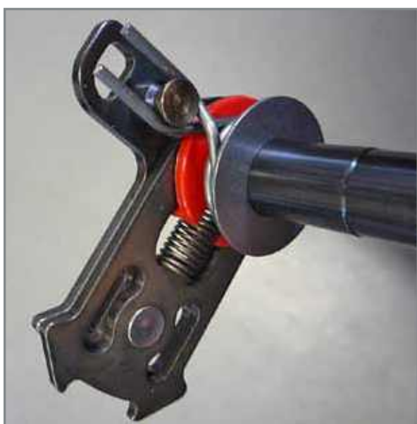
Arbre de commande de boîte: à noter le positionnement de la ressort de retour de commande de boîte.
