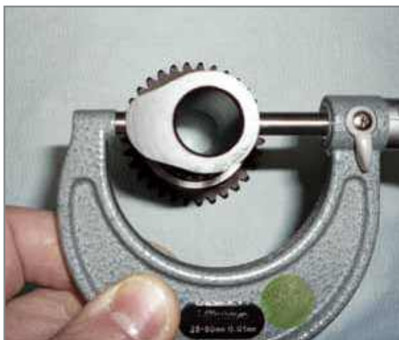
Mesure de la hauteur des cames.
