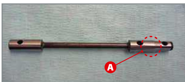
Contrôle de l'arbre de commande des pompes à huile.
