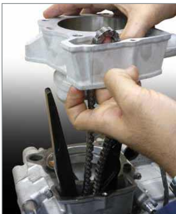
Phase du passage de la chaîne dans le cylindre.
