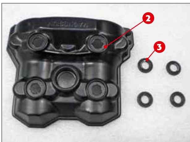
Le couvercle de culasse 2 et les quatre joints 3.
