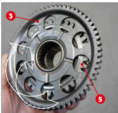
Pignon en bout de vilebrequin doté d'une roue libre couplés à l'engrenage de démarrage.
