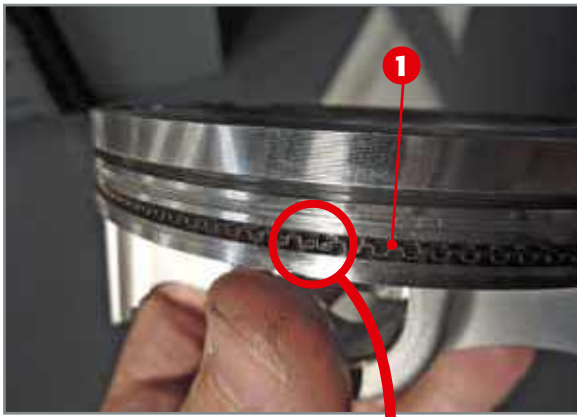
Montage du ressort du segment racleur.
