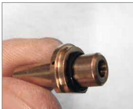
Détail du gicleur d'huile de lubrification 1.
