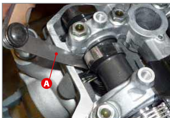
Contrôle du jeu des soupapes grâce à la jauge d'épaisseur.
