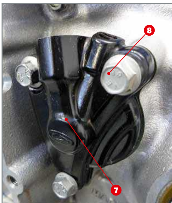
L'actionneur hydraulique 7 et les trois vis 8 de couplage au demi-carter.
