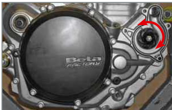
Application du carter d'embrayage interne complet au carter droit.
