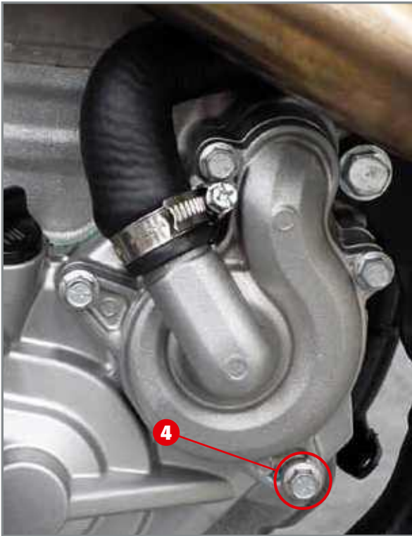
Vis 4 d'écoulement du liquide de refroidissement.
