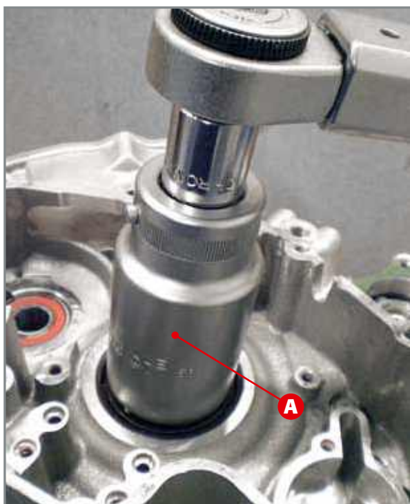
Extraction de l'écrou de blocage de l'arbre moteur avec la douille spéciale A.
