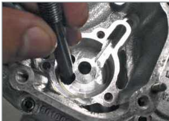
Extraction du côté de la pompe à huile de basse pression.
