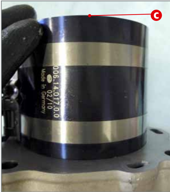
Montage du piston sur le cylindre.
