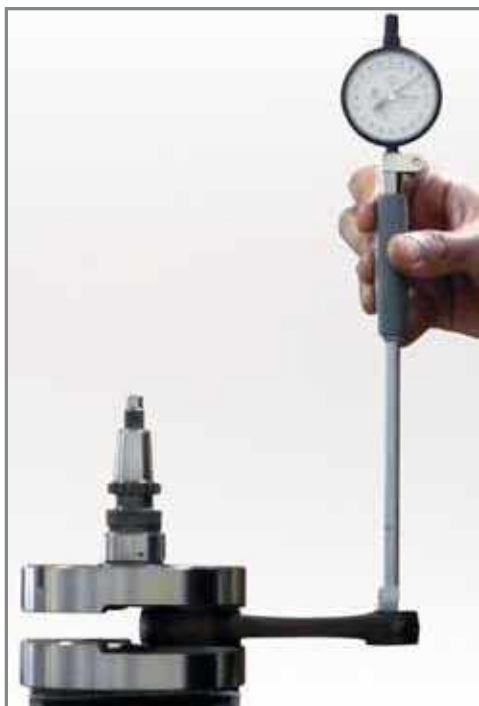
Contrôle à l'aide du dispositif de mesure de l'alésage du diamètre interne équivalent à celui du pied de bielle.
