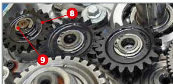
Couplage de la roue de commande de la pompe.
