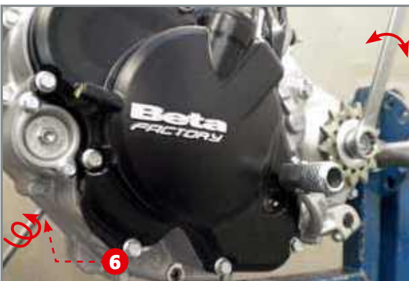
Blocage du vilebrequin au PMH. Noter la vis de blocage 6 et le mouvement imposé à l'arbre de sortie à l'aide de la clé fixe.
