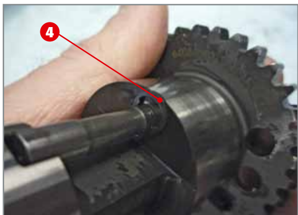
Extraction de la bague benzing de l'arbre du décompresseur.
