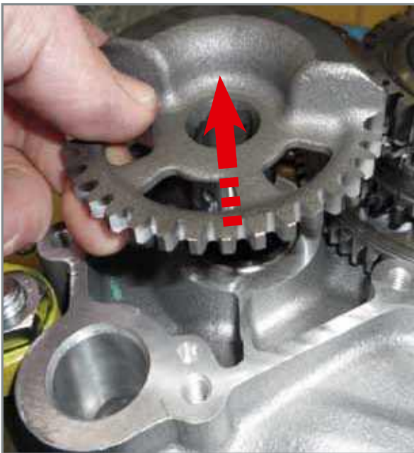
Extraction de l'arbre d'équilibrage.
