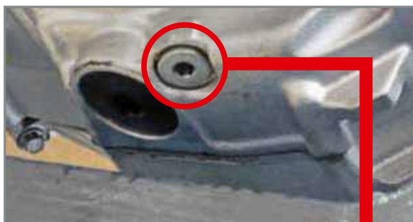
Emplacement de la soupape de régulation de la pression.
