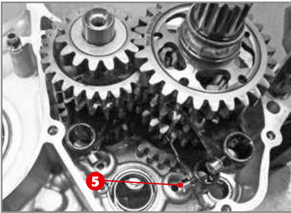
Extraction des fourchettes du groupe de boîte de vitesse.
