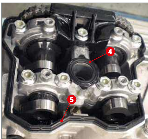
Le joint de puits de bougie 4 et le joint du couvercle de la tête 5.
